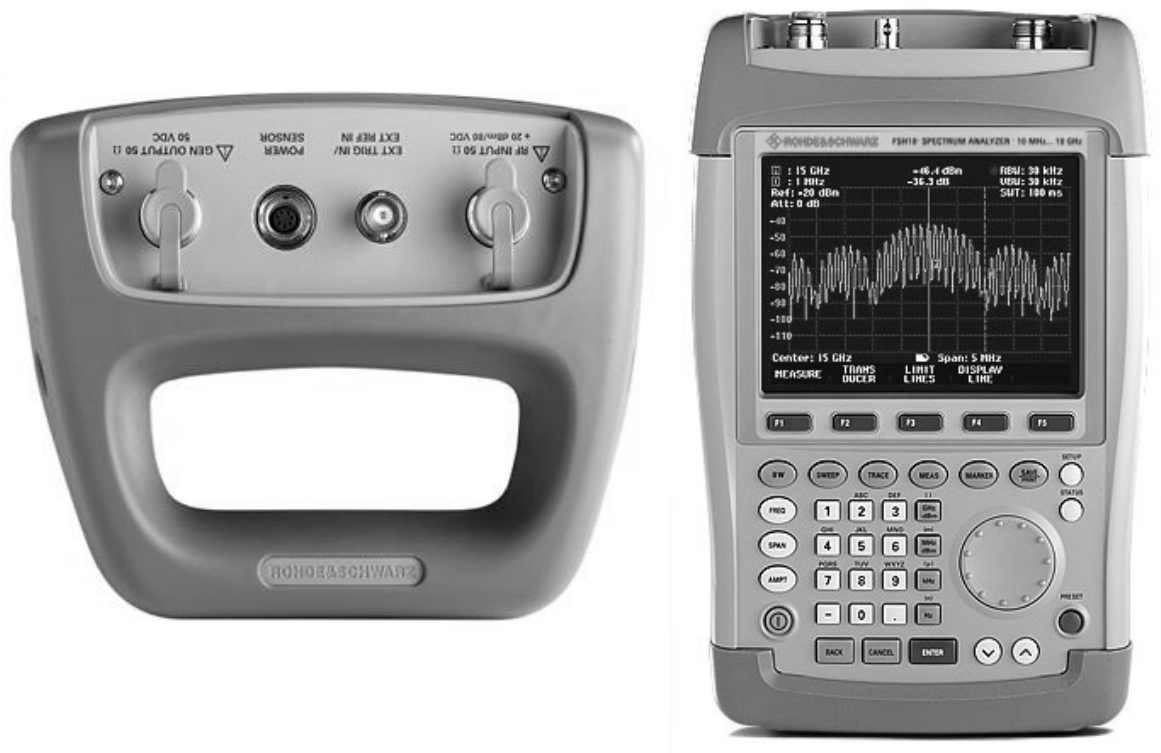
Obr. 47. Spektrální analyzátor FSH3 R&S.
