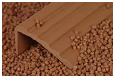
Obr. 6. Granulát PVC a vytlačný výrobek [24]
