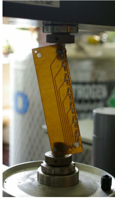
Obr. 54. Zkušební DPS na tahovém stroji
