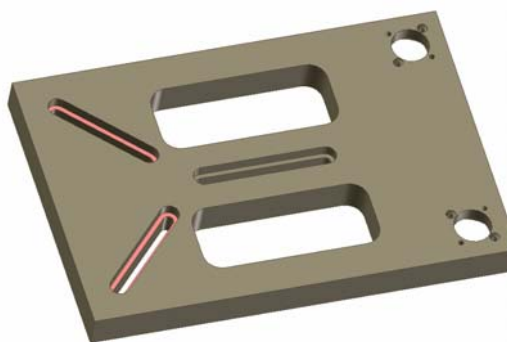
Obr. 50. Vodící drážky pro napínací pevné čepy – zadní strana upínací desky
