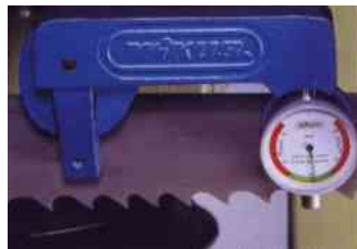
Obr. 14. Měřicí zařízení k napínání pilového pásu
