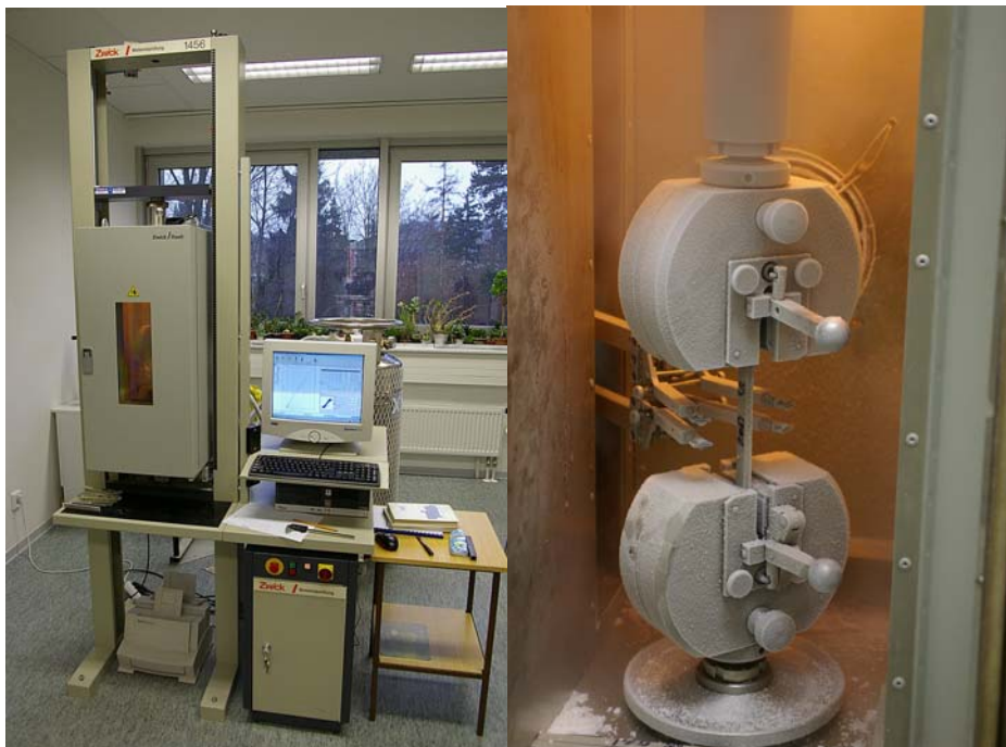
Obr. 53. Universální zkušební stroj s teplotní komorou
