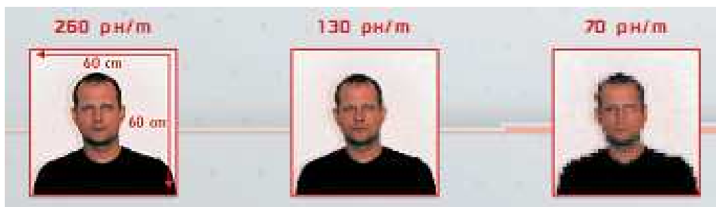
Obr. 9. Snímaná scéna s různým počtem pixelů/metr [13]
