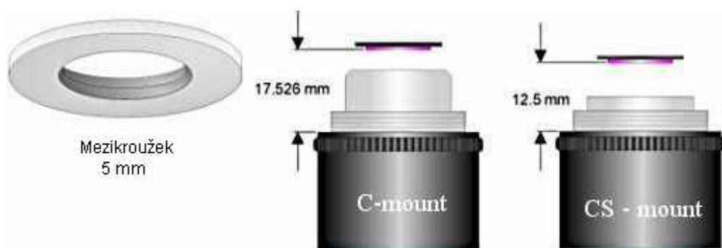
Obr. 12. Způsob uchycení objektivů ke kameře
