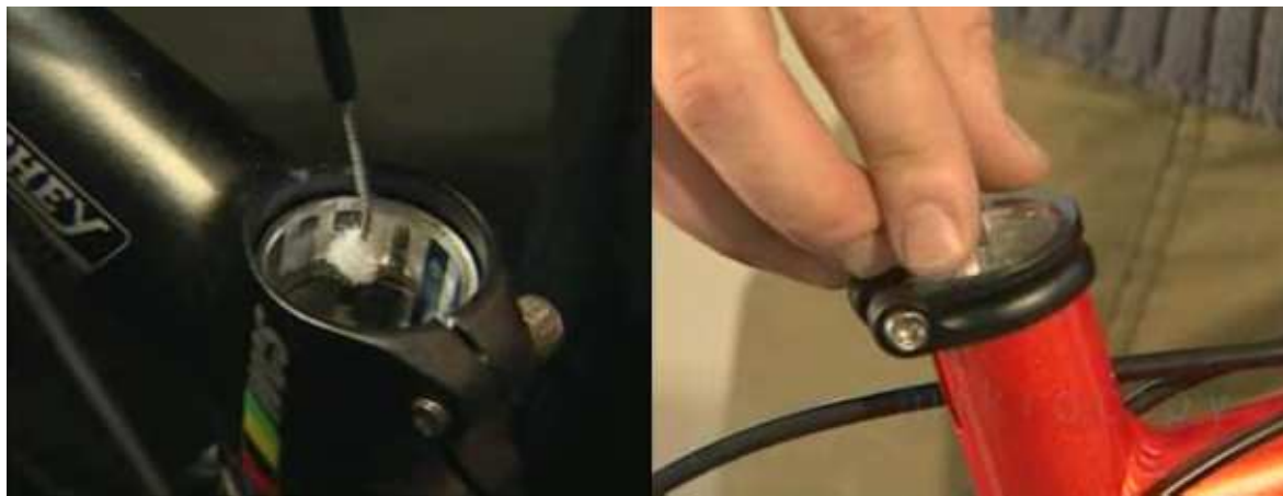
Obr. č. 40 Aplikace mikroteček a mikročipu do sedlové trubky kola
