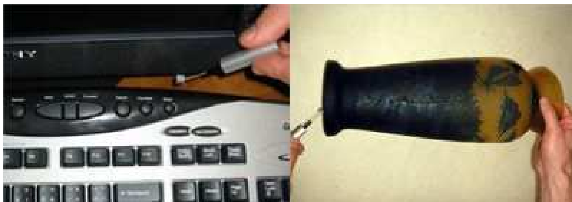
Obr. č. 41 Aplikace mikroteček na monitor a starožitnou vázu
