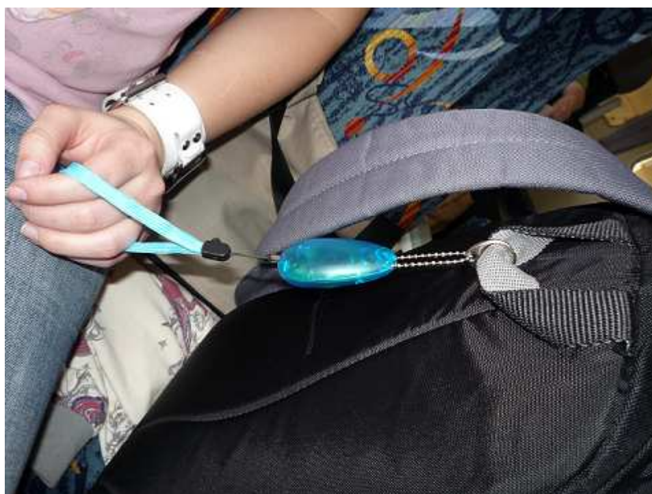
Obr. č. 30 Použití osobního alarmu s aktivací po vytrhnutí kolíčku na ochranu batohu
