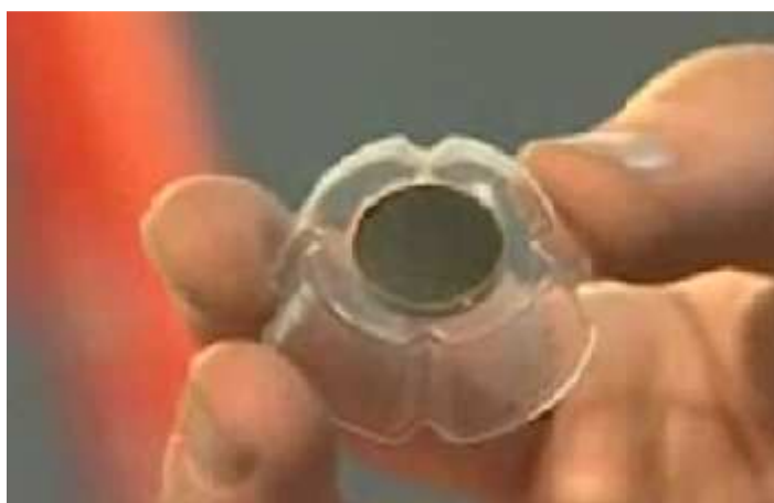
Obr. č. 22 Mikročip vhodný do sedlové trubky kola
