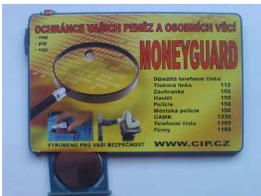
Obr. č. 8 Umístění baterie v alarmu Moneyguard
