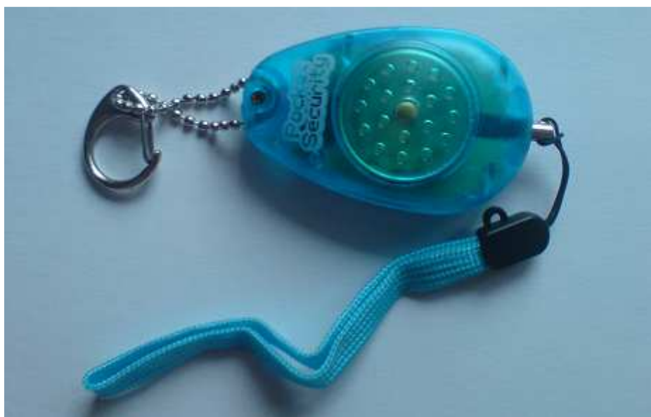
Obr. č. 3 Osobní alarm s aktivací po vytrhnutí kolíčku
