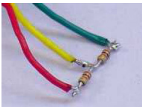
Obrázek 32 Odporový dělič 2x 2k7
