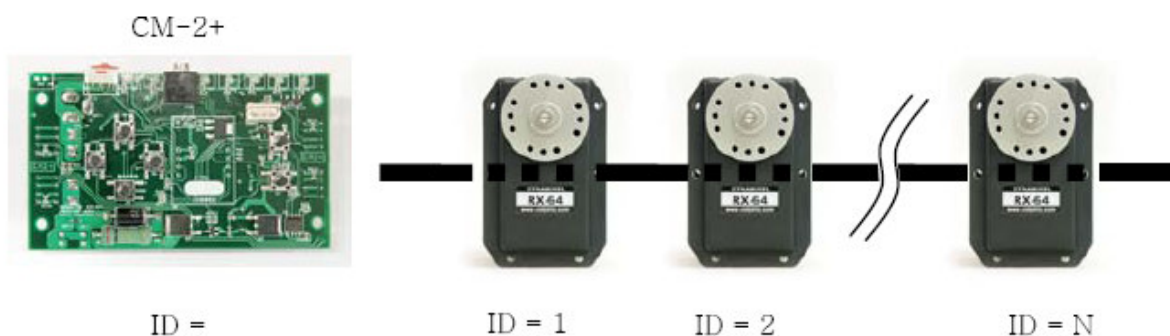
Obrázek 22 Schématické naznačení zapojení a identifikace motorů RX 64[6]
