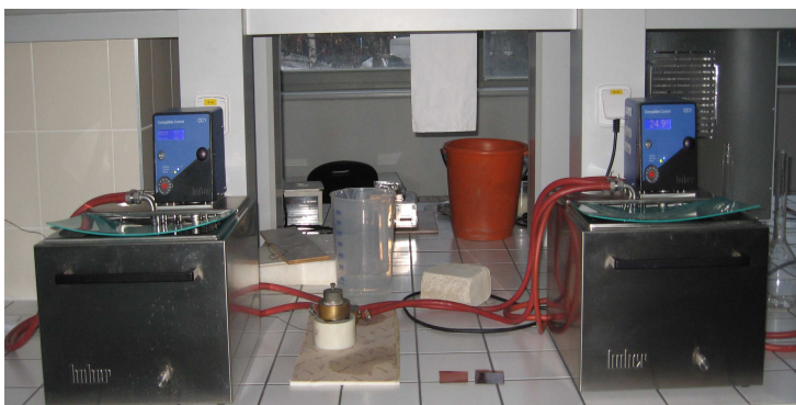
Obr. č. 14 Nestacionální měření tepelné vodivosti podle Fitcha.
