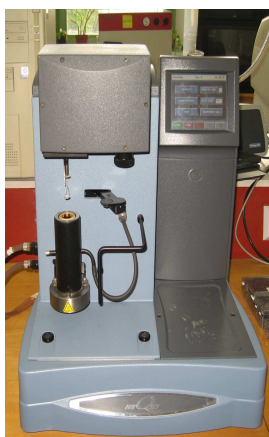
Obr.č. 16 Příklad přístroje pro měření TGA METTLER TOLEDO STARE.
