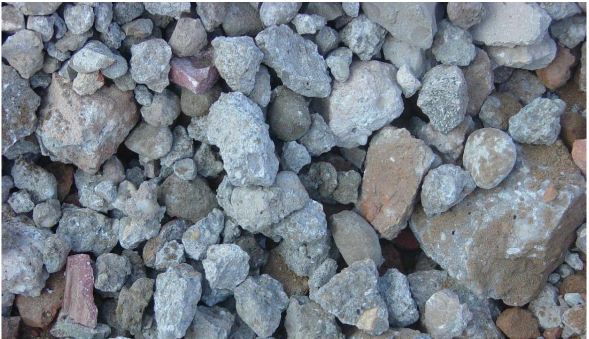
Obr. 24 Zpracovaný stavební recyklát (beton) [VZ]
