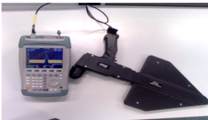
Obr. 4.16: FSH3 se směrovou anténou
