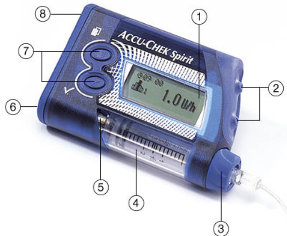
Obr.7 Schéma inzulinové pumpy - 1. otočný displej s podsvícením a textovými hlášenými v češtině, 2. dvě tlačítka pro správné programování bonusu, 3. adaptér se standardním konektorem (typu luer), 4. zásobník s inzulinem o objemu 3,15 ml, 5. integrovaný pohybový teleskopický trn, 6. infračervený port pro programování, 7. jednoduché listování pomocí dvou tlačítek, 8. jedna baterie AA (alkalická)
