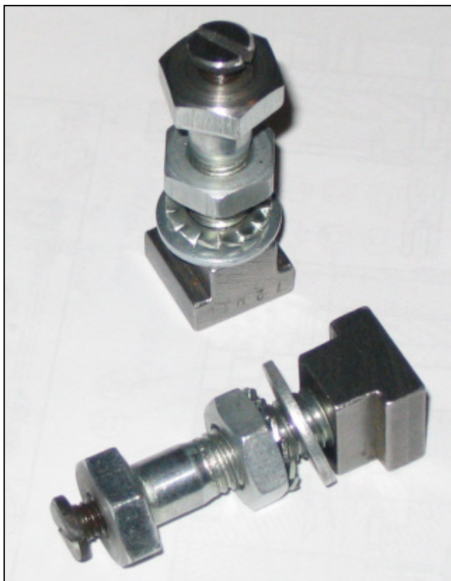
Obr. 52. Šrouby pro instalaci hliník. profilu osy Z
