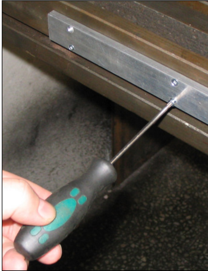
Obr. 42. Sešroubování dvou částí hliníkového profilu
