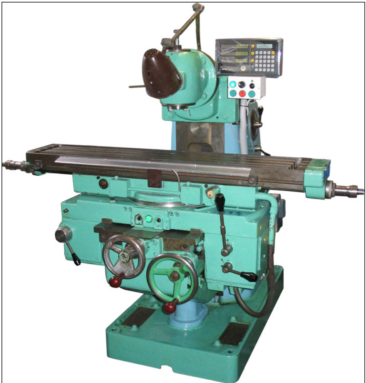
Obr. 66. Konečný stav po instalaci odměřovacího systému
