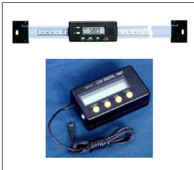
Obr. 10. Vestavné měřidlo s LCD výstupem
