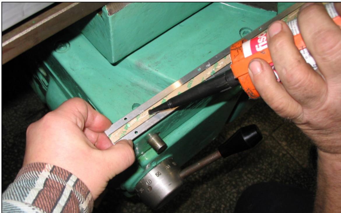
Obr. 40. Zajištění magnetické pásky proti posuvu v hliníkovém profilu
