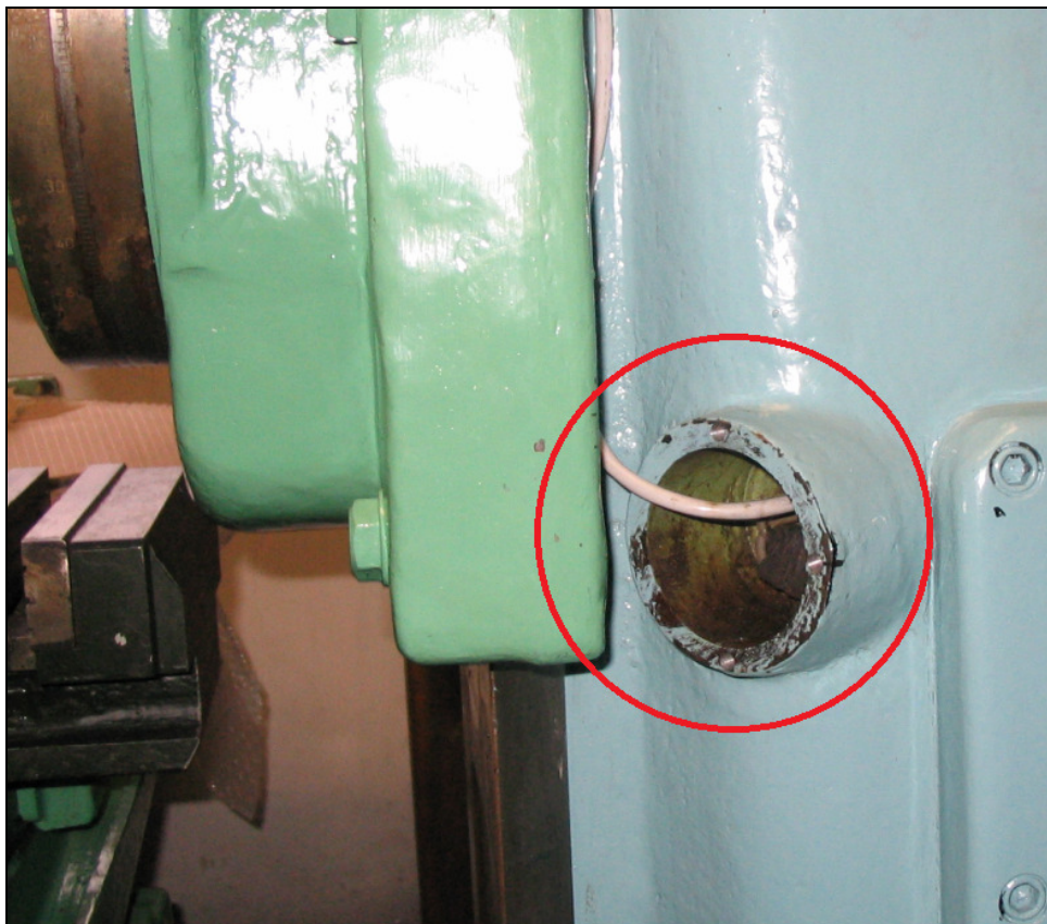
Obr. 35. Otvor pro ampérmetr - díry se závitem M6
