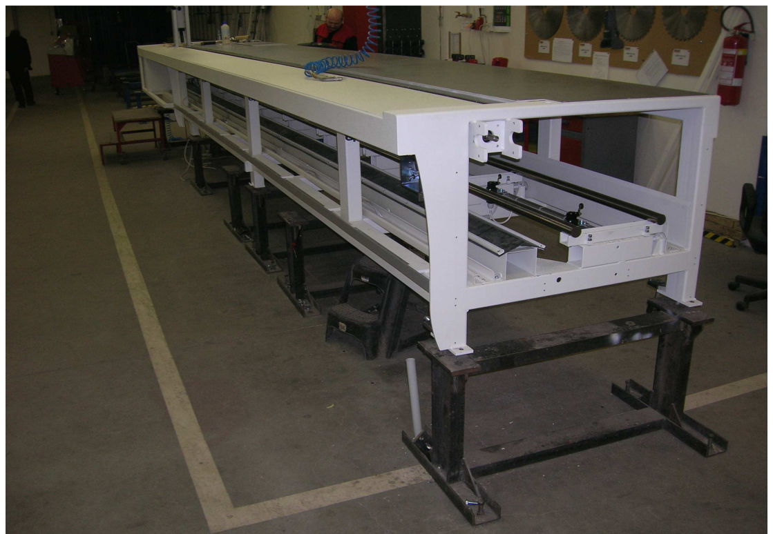
Obr. 11. Nalakovaný rám stroje
