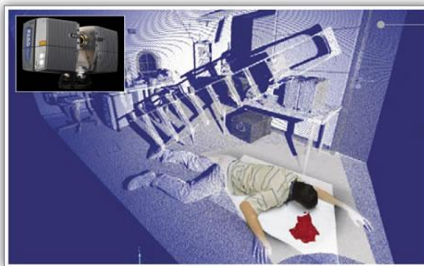
Obr. 15. Ukázka skenu místa činu pomocí skeneru FARO Photon 120
