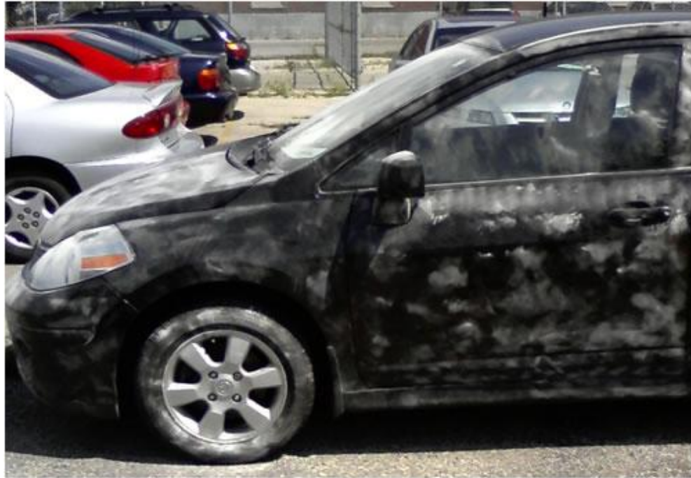
Obr. 36. Automobil předem pokrytý bílým pudrem pro zlepšení vlastností povrchu
