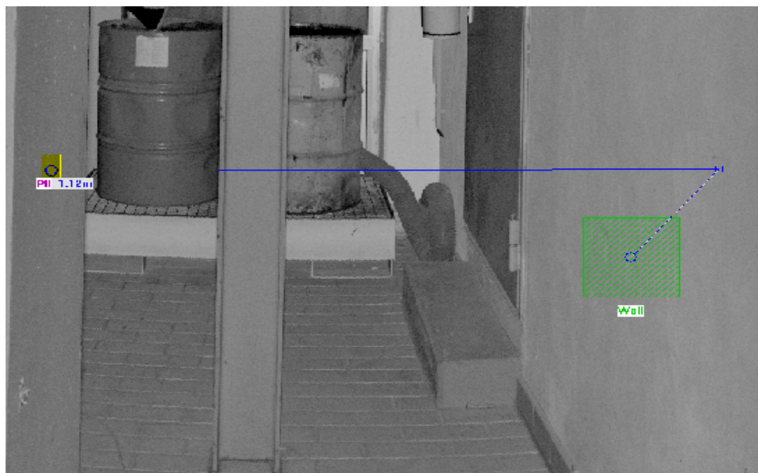
Obr. 28. Ortogonální měření mezi dvěma plochami
