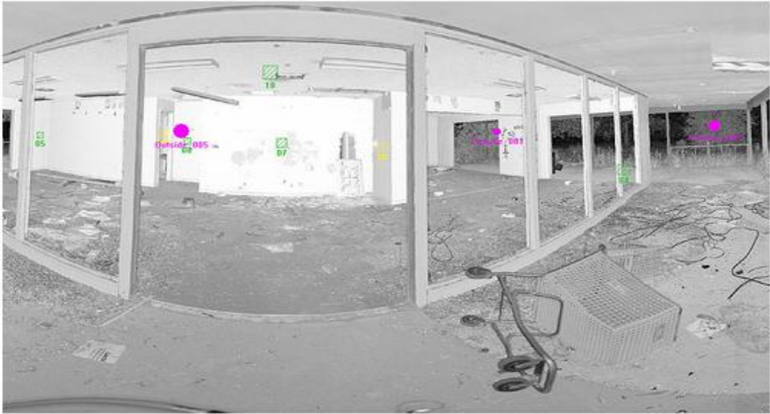
Obr. 19. Základní černobílý sken FARO Photon 120
