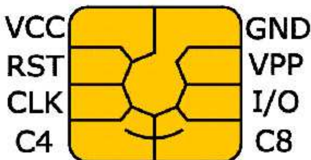
Obr. 4. Kontaktní plošky čipové karty [1]
