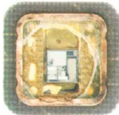
Obr. 18. Čip odkrytý leptáním [9]
