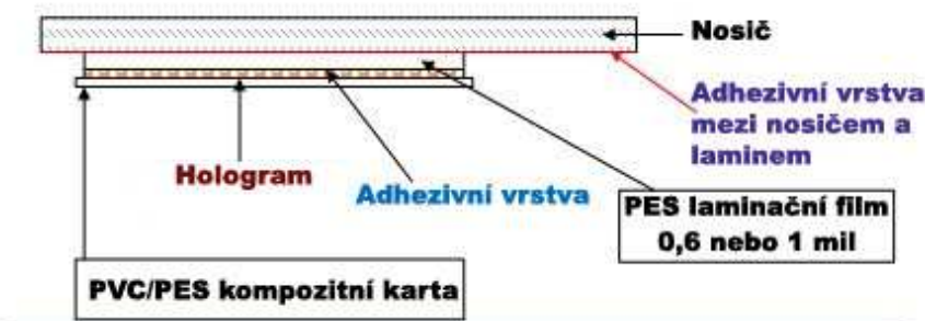
Obr. 15. Struktura karty s hologramem [12]
