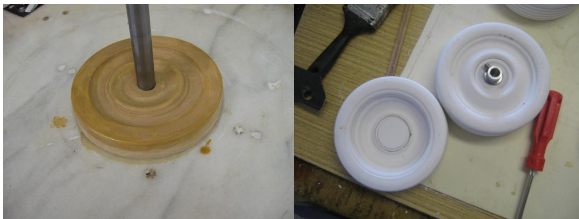
Obr. 46. Našelakovaná část formy a hotové sádrové výrobky
