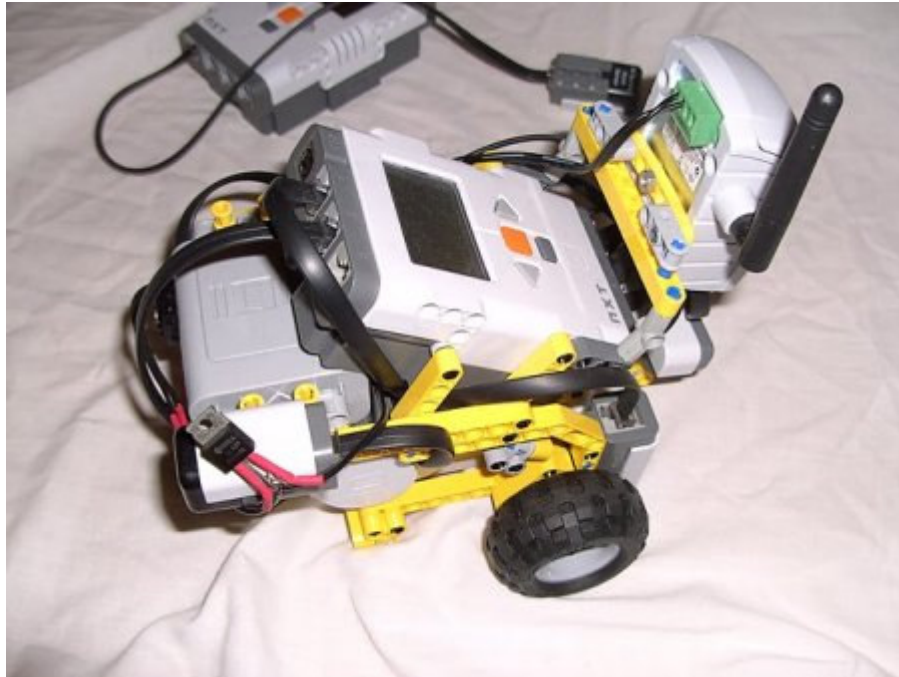
Obr. 63. V popředí je Techbricks NXT bot a v pozadí je druhá NXT kostka se senzorem akcelerace[20]
