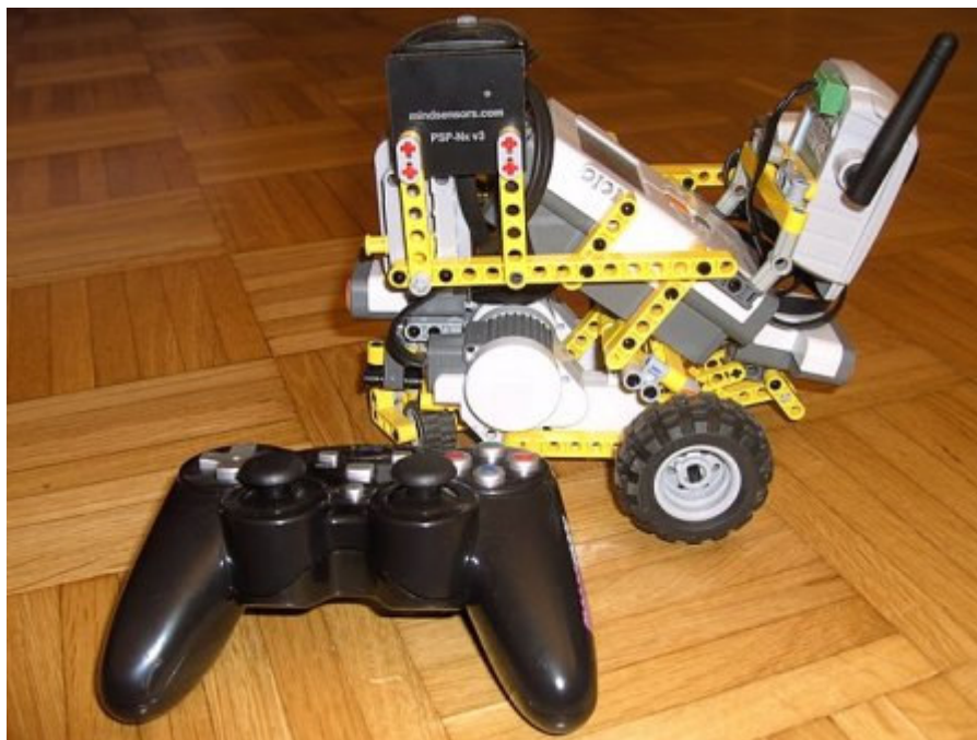
Obr. 64. V popředí je gamepad konzole PS2 a v pozadí je Techbricks NXT bot s kontrolním rozhraním pro PS2[20]
