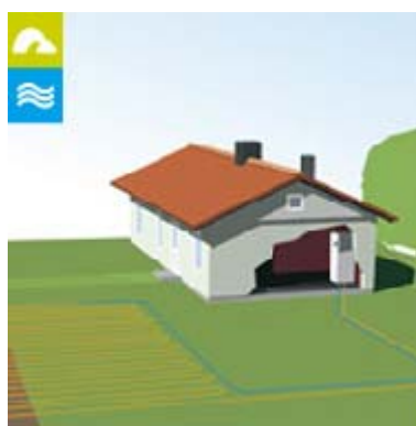
Typ zem-voda – zemný kolektor
