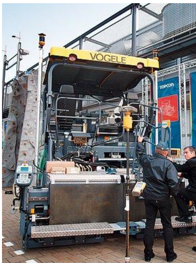
Obrázek 52 Finišer VÖGELE řízený přijímačem GR-3 GNSS TOPCON 75
