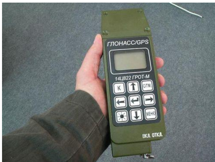
Obrázek 18 Vojenský ruční kombinovaný přijímač GLONASS/GPS využívající metod kódového měření 26
