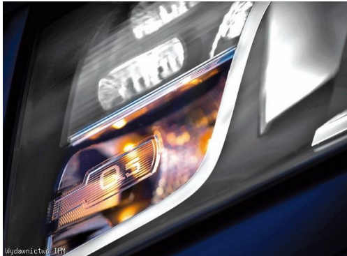
Obrázek 2 Kryt na světlo a plastový vstříkovaný díl
