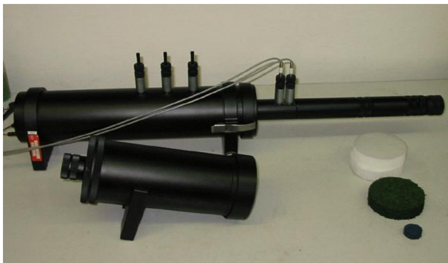
Obr. 32. Kundtova impedanční trubice a vzorky pro měření koeficientu zvukové pohltivosti [26]
