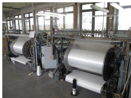
Obr. 19. Horní role pro osnovní nit, dolní role pro hotovou tkaninu a skladování tkanin (CANON PowerShot G10)
