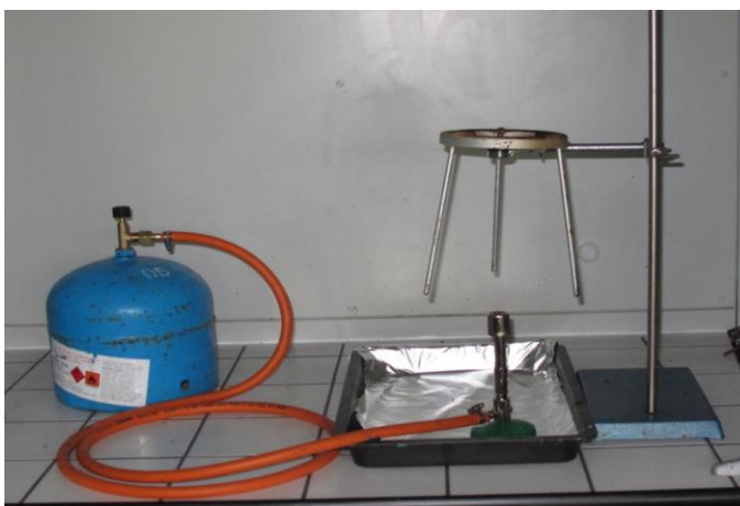
Obr. 37. Aparatura pro měření zkoušek v ohni (CANON PowerShot G10)
