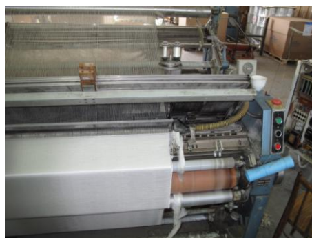
Obr. 17. Tkací stroj a mechanismus tkaní (pro útkovou nit vzduchový mechanismus) (CANON PowerShot G10)
