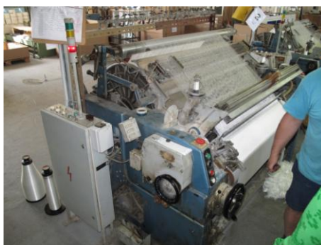
Obr. 17. Tkací stroj a mechanismus tkaní (pro útkovou nit vzduchový mechanismus) (CANON PowerShot G10)
