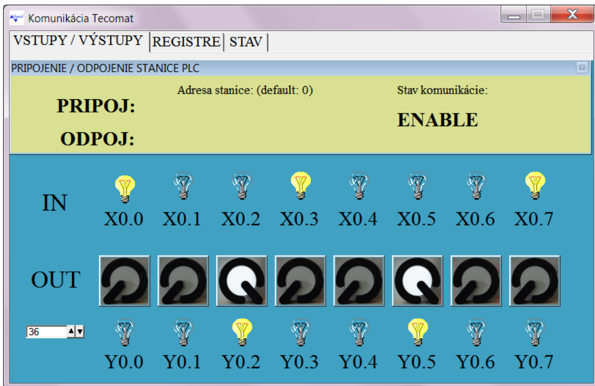
Obr. 52. Indikácia vstupov a voľby stavov výstupov
