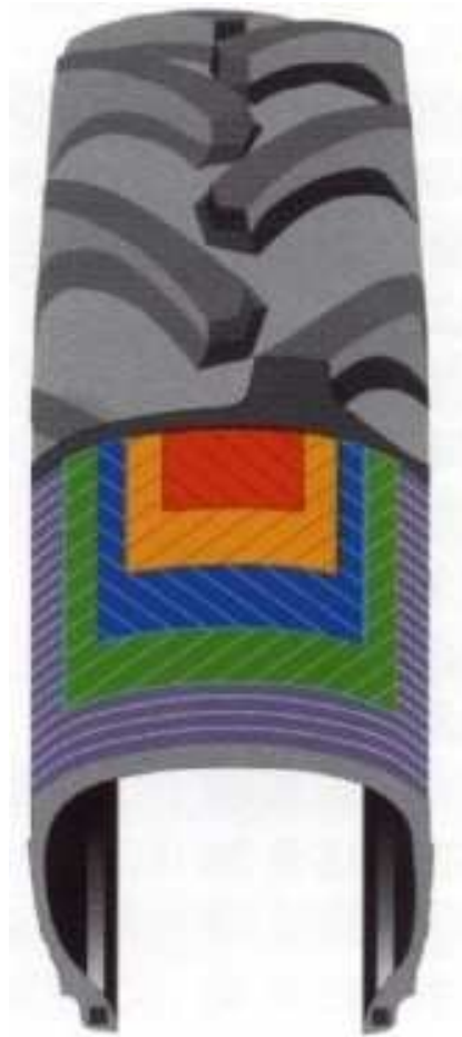
Obr. 4. Plášť radiální konstrukce [7]
