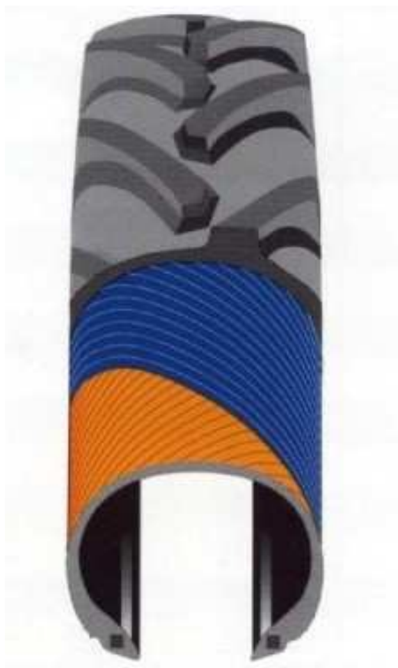
Obr. 5. Plášť diagonální konstrukce [7]
