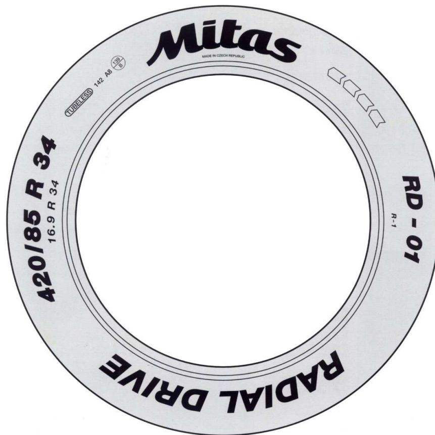
Obr. 6. Popis bočnice pláště [7]
