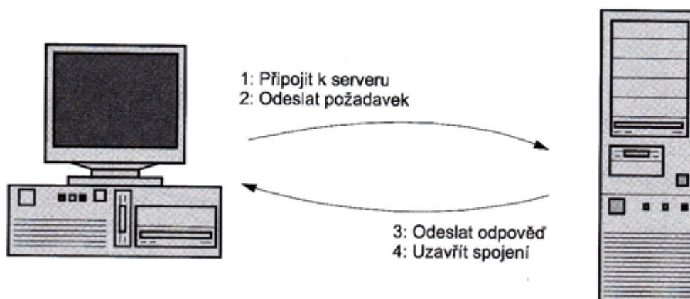
Obr. 2 – Aplikace typu Klient-Server (převzato[3])
