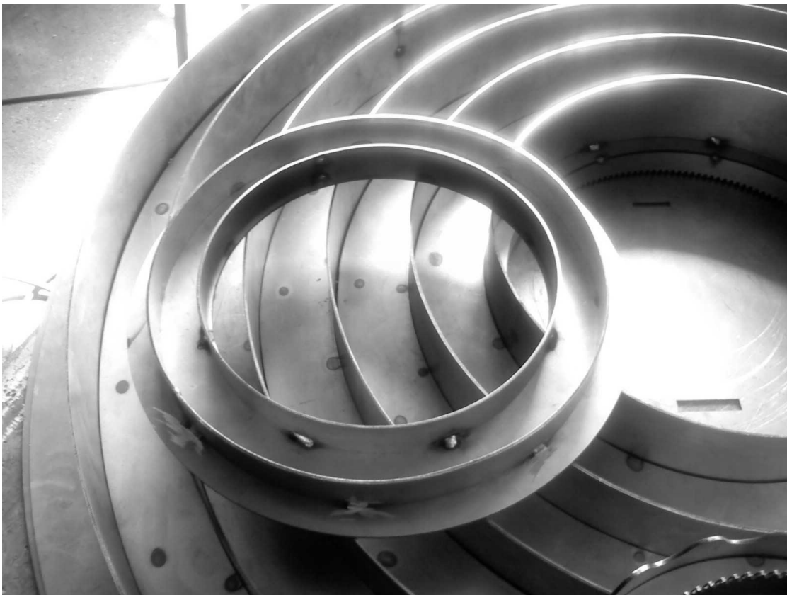
Obr. 22 Svar dráhy s podpěrami
