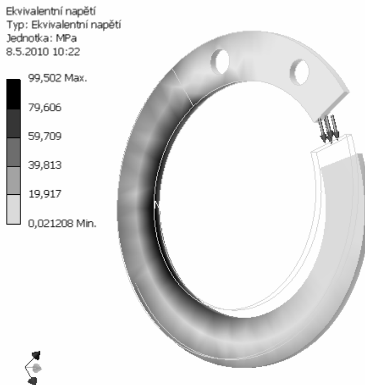
Obr. 17 Pružina při roztáčení – ekvivalentní napětí
