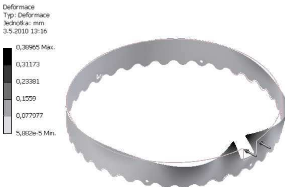
Obr. 15 Kontrola průchodu – deformace
