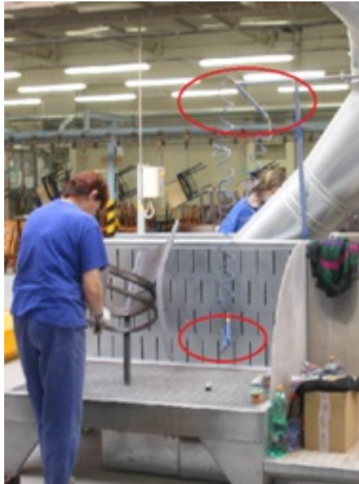
Obrázek 36 Nevhodně visící hadice se vzduchem [vlastní zpracování]
