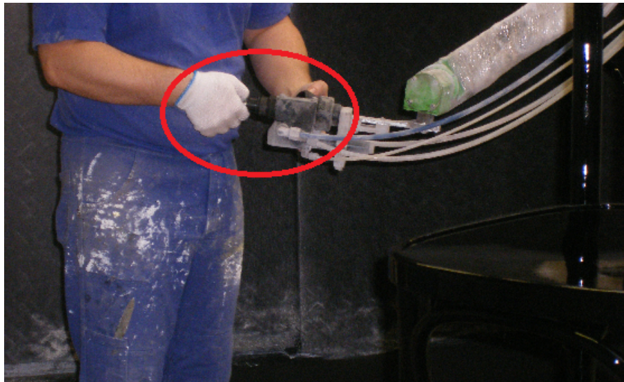
Obrázek 26 Čištění šroubu hlavice robota [vlastní zpracování]
