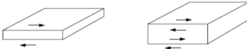
Obr. 5: Základní a harmonický režim namáhání na střiž
