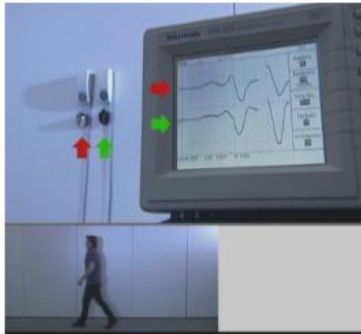
Obr. 9 Test chůzí (PIR detektor s bílým zrcadlem je označen červenou šipkou a PIR detektor s černým zrcadlem je označen zelenou šipkou) [18]
