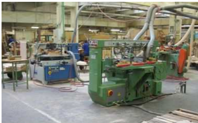
Obr. 16 Pracoviště dlabání opěradlových noh [vlastní]
