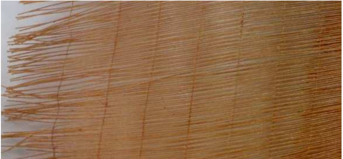
Obr. 13. Detail kordové tkaniny. (3)
