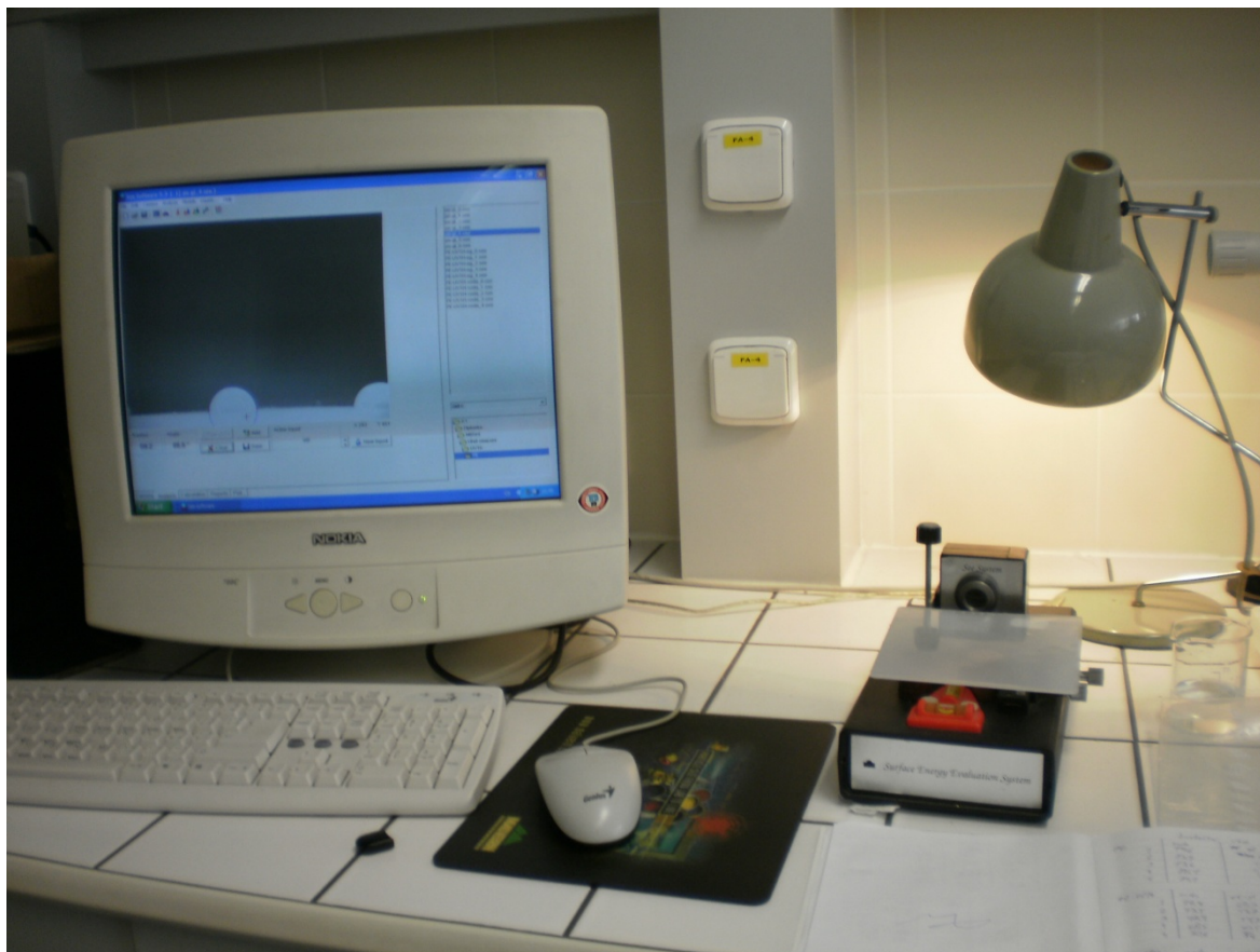
Obr. 40 See systém – zařízení pro měření kontaktního úhlu sedící kapky.
