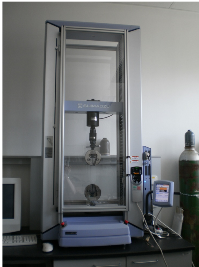
Obr. 16 Trhací stroj pro tahové zkoušky Ultra-High-Precision Universal Testing Machine AG-X (Shimadzu, Japan).
