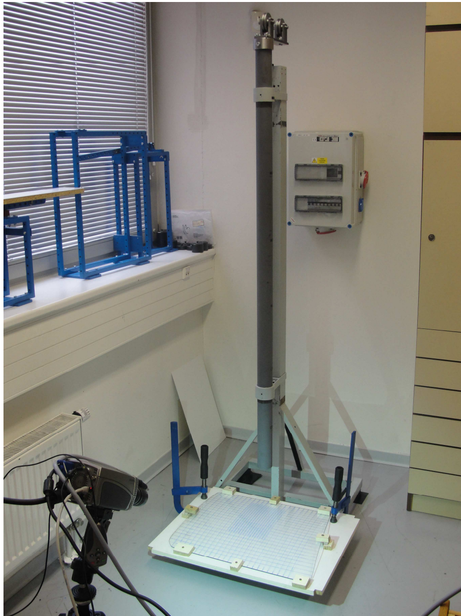
Obrázek 8 Pracoviště pro pádovou zkoušku
