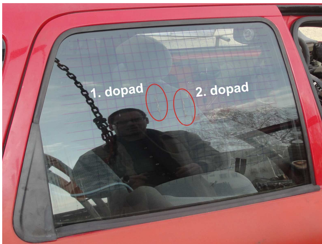
Obrázek 26 Stopy po 1. a 2. dopadu na autosklo s bezpečnostní fólií
