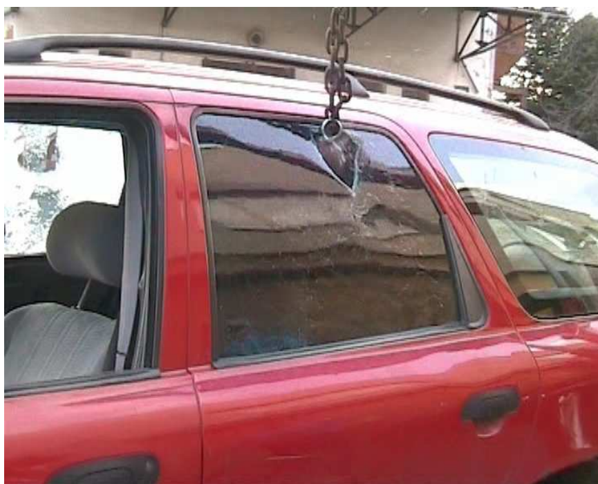
Obrázek 34 Proražení skla a protrhnutí fólie – úder č. 8
