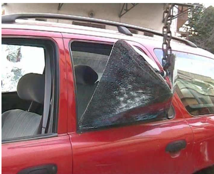
Obrázek 36 Vytržené celé sklo s fólií
