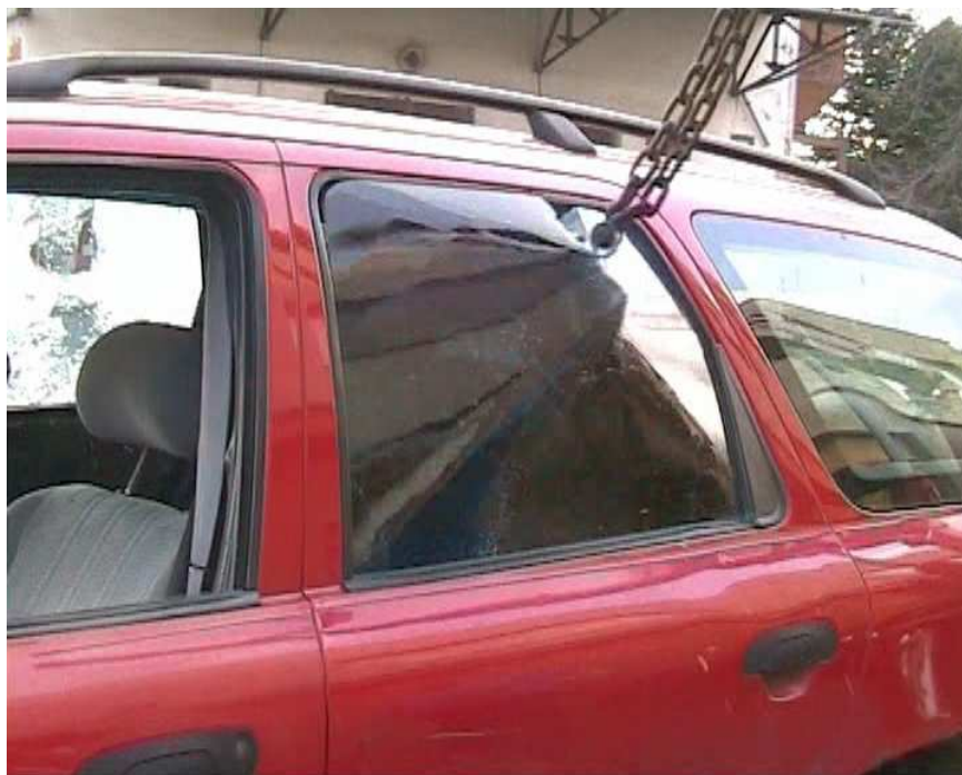
Obrázek 35 Vytrhávání skla s fólií
