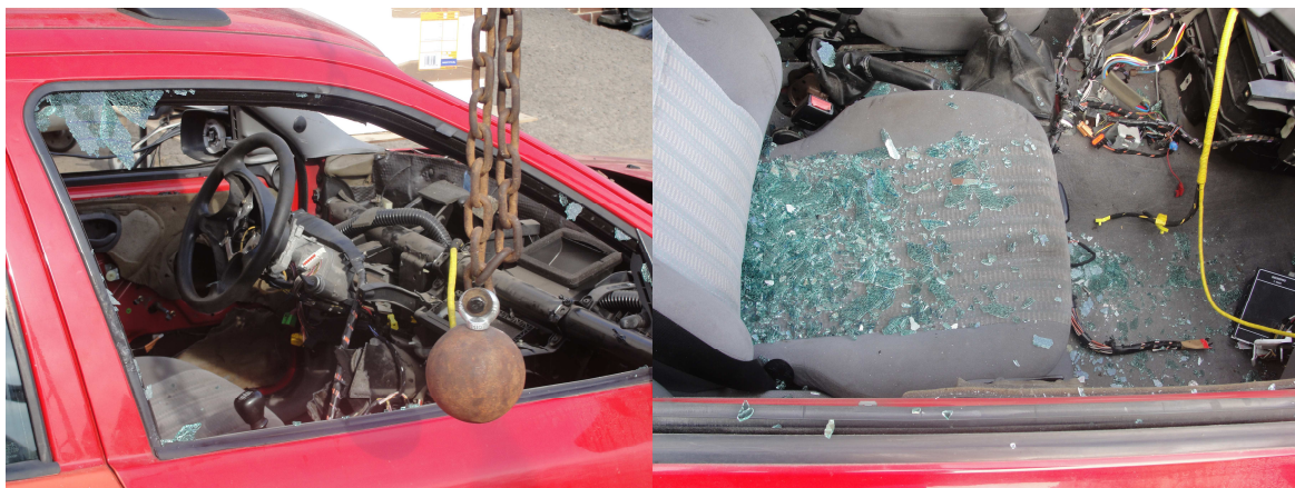
Obrázek 18 Roztříštěné sklo Sekurit
