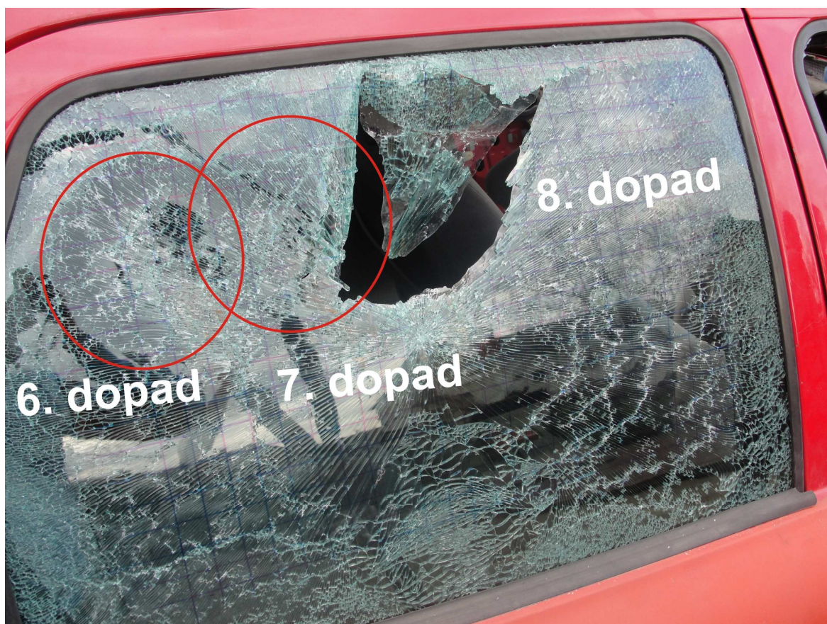
Obrázek 31 Protrhnuté sklo s bezpečnostní fólií
