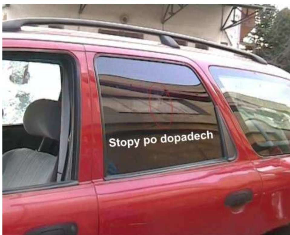
Obrázek 32 Stopy po dopadech kyvadla na sklo s protisluneční fólií
