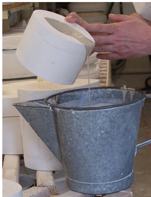
Obr.46 Vylití zbytku porcelánové hmoty
