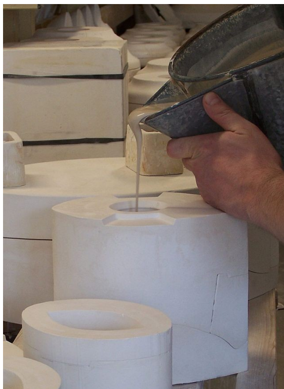
Obr.45 Ruční lití do sádrové formy
