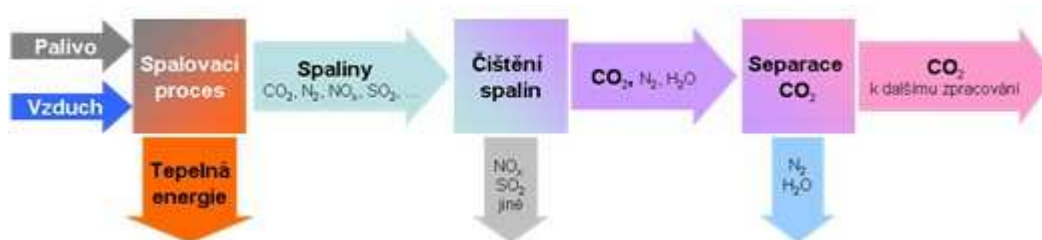
Obr. 3. Schéma technologie při spalování se vzduchem [7]
