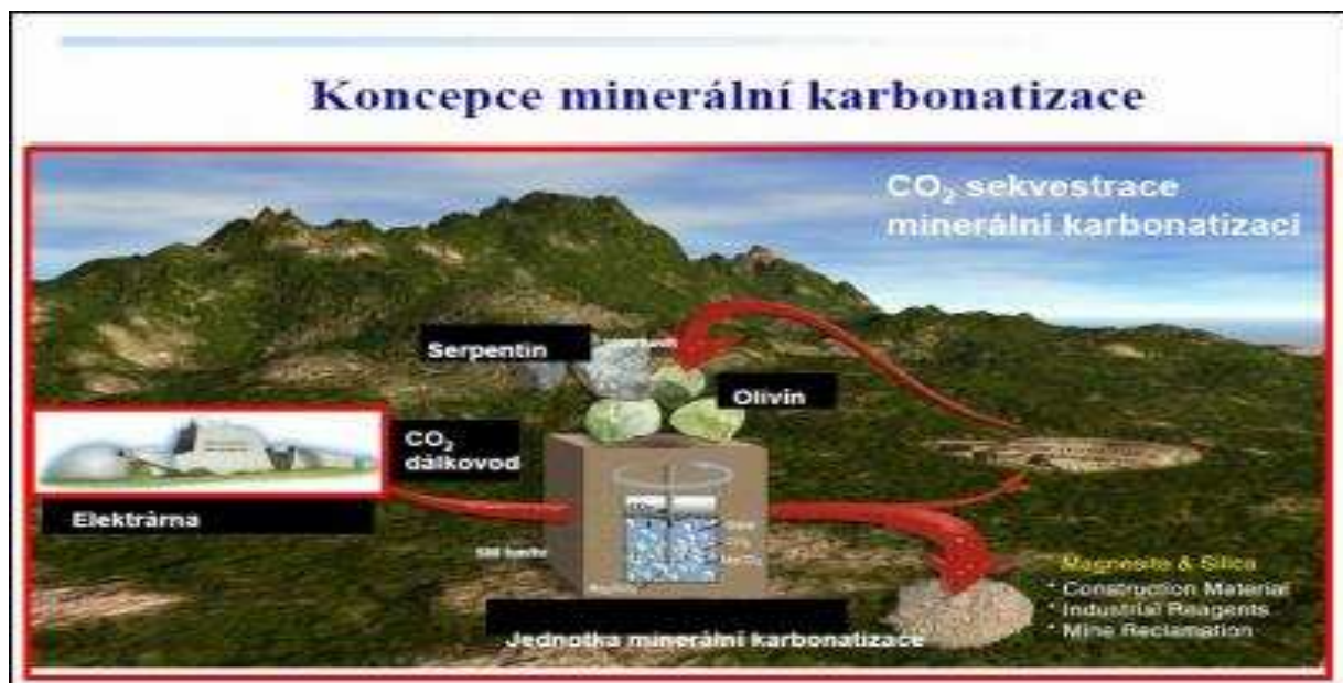
Obr. 7. Schéma ukládání CO 2 technologií minerální karbonatizace [9]
