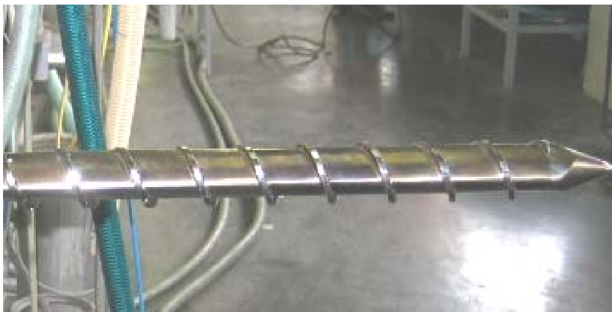
Obrázek 32 povrch šneku po zkoušce receptury PVC1962 R0050
