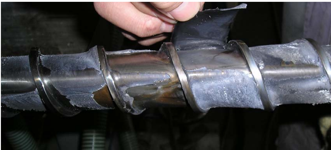
Obrázek 20 vrstva PVC na povrchu šneku
