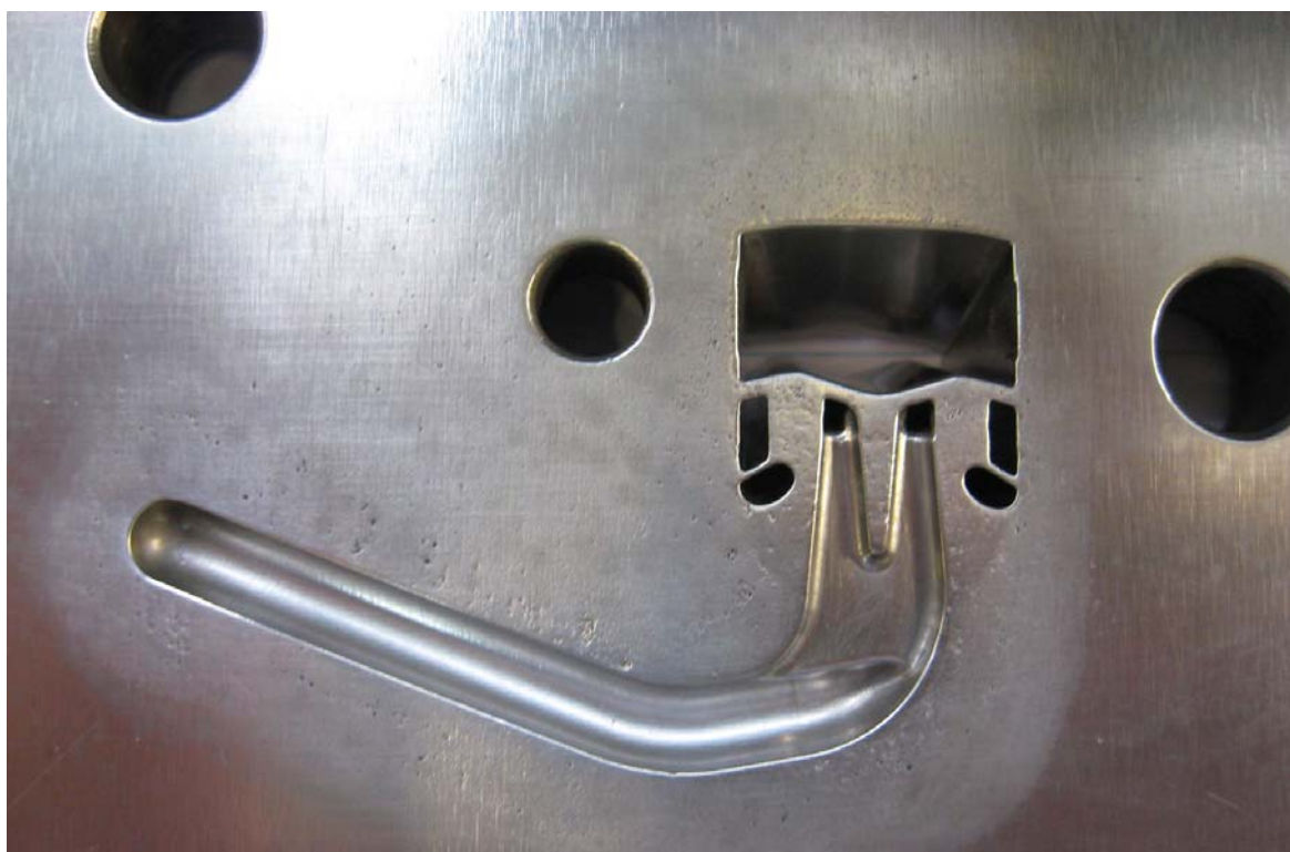
Obrázek 29 opotřebení desek vytláčovací hlavy Elmax
