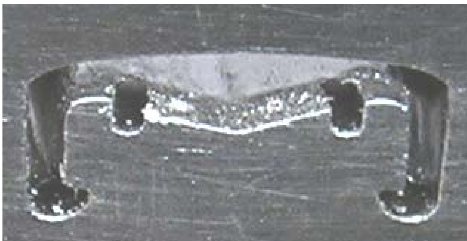
Obrázek 27 abrazivní opotřebení oceli 1.2316
