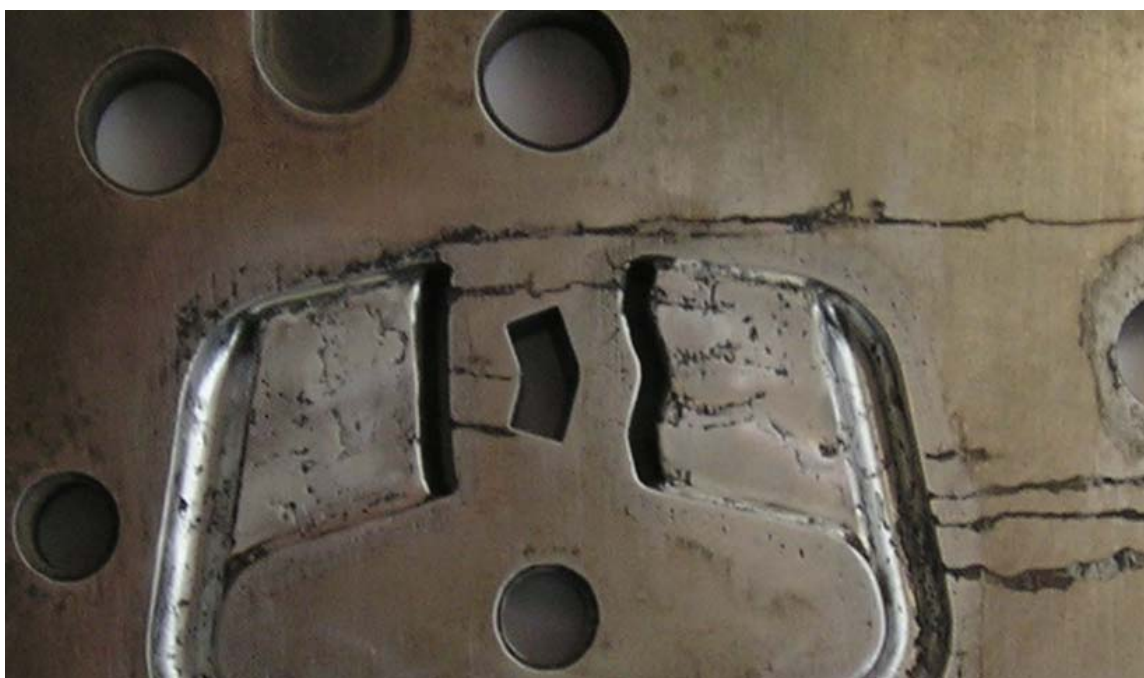
Obrázek 24 poškození mezidesky vytlačovací hlavy
