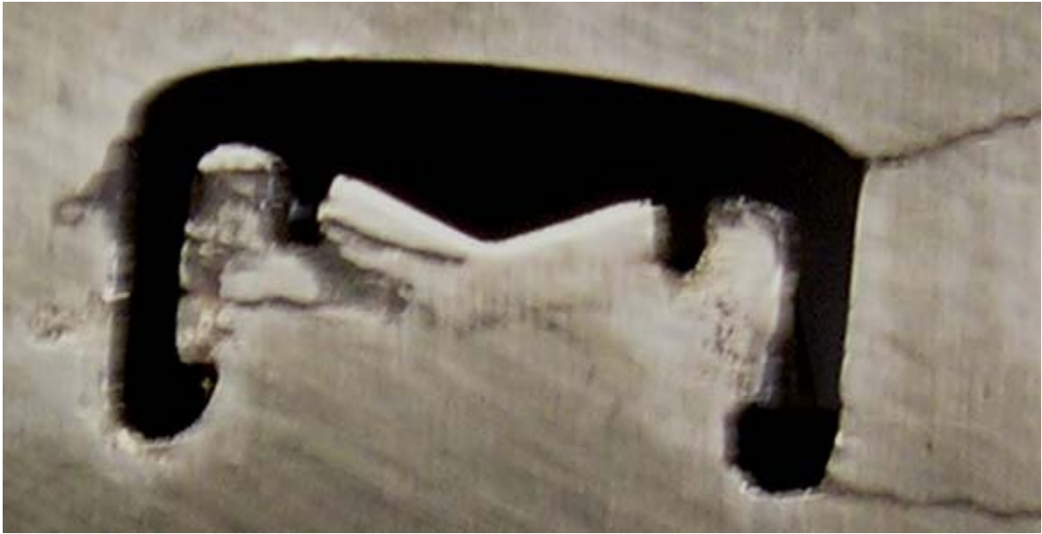
Obrázek 28 koroze povrchu nitridovaného nástroje
