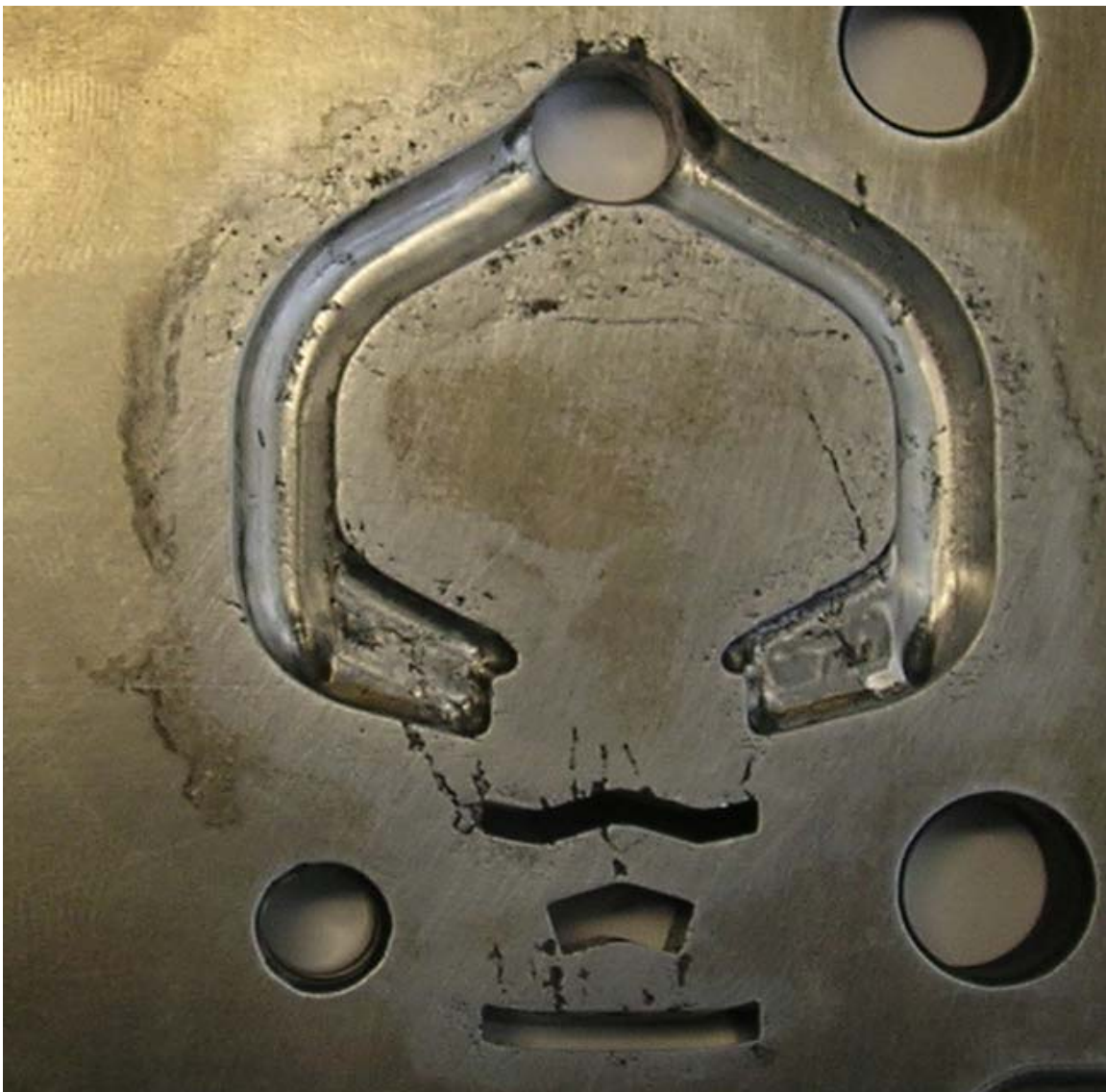
Obrázek 22 koroze kanálů vytlačovací hlavy
