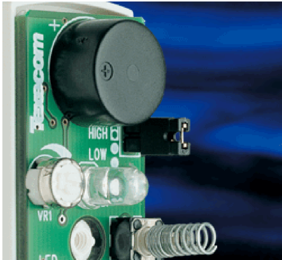
Obr. 17. Detail piezoelektrického senzoru u detektoru Impaq plus
