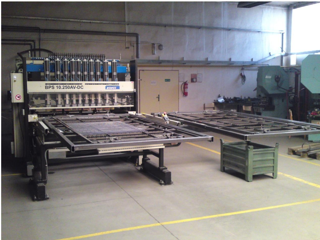
Obrázek 20 Svářecí poloautomat na bodování sítí [vlastní zpracování]
