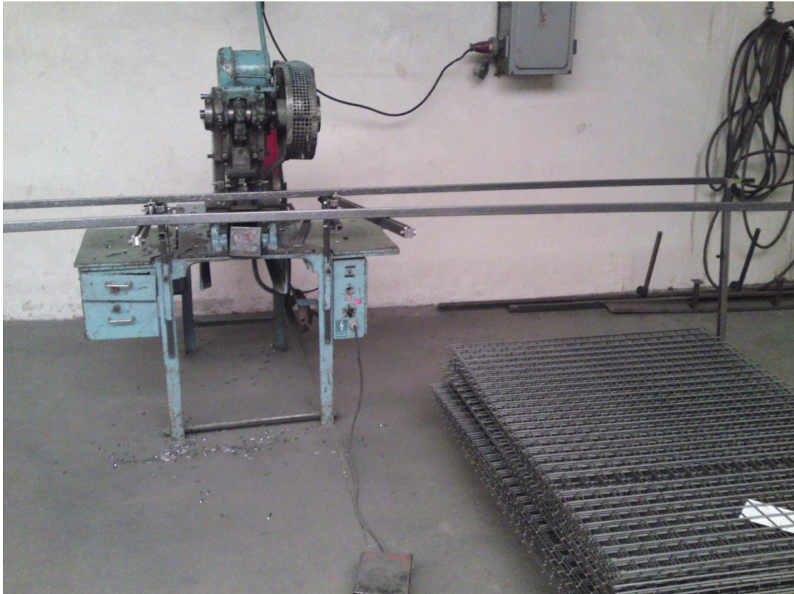
Obrázek 22 Ostríhané sítě pomocí ostríhovačky [vlastní zpracování]
