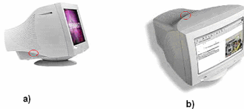
Obr. 44. Místa měření u CRT monitoru
