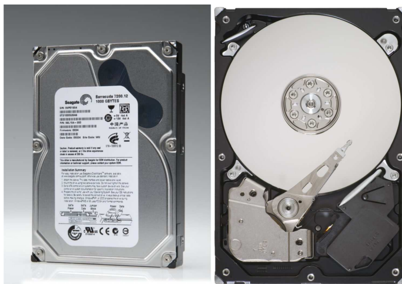
Obr. 3.5.1 Pevný disk zvenku i zevnitř
