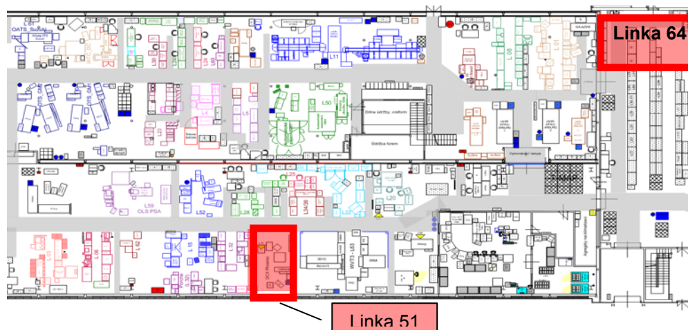
Obr. 11. Situace po transferu - současný layout výrobní haly [vlastní zpracování]
