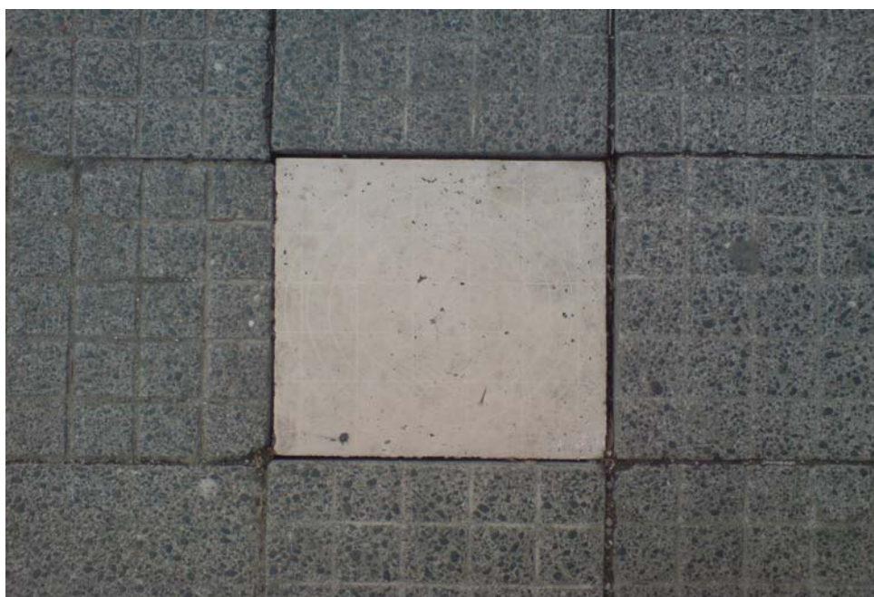
Obr. 15. Měsíc po umístění geopolymerní dlažební kostky
