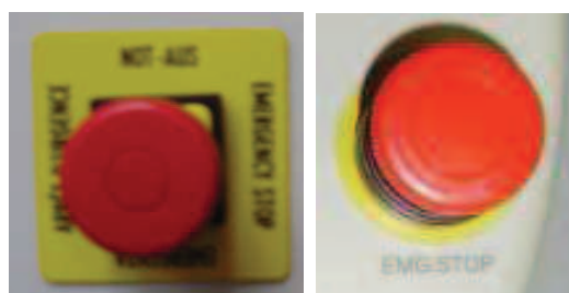
Obr. 50: Tlačítka nouzového zastavení
