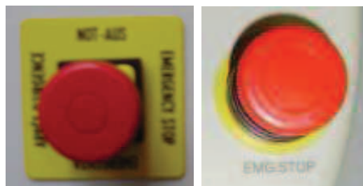
Obr. 69: Tlačítka nouzového zastavení
