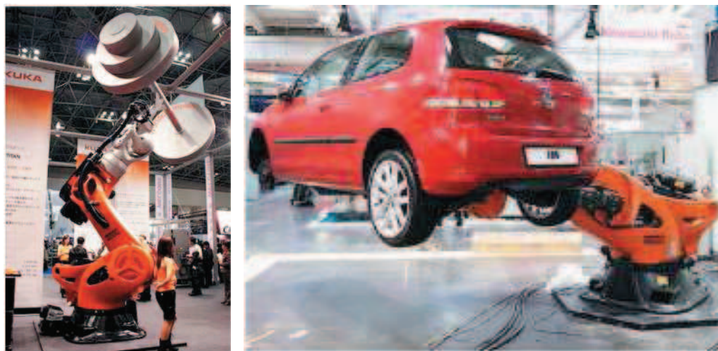
Obr. 5: Robot KR 1000 Titan s nosností 1000 kg [1]
