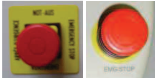
Obr. 10: Tlačítka nouzového zastavení
