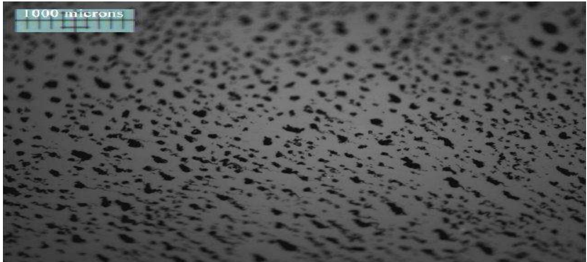
Obr. č. 49 – suspenze C2 - výřez B (PVAL+nanočástice) – polystyrenová Petriho miska – působení kolmým magnetickým polem
