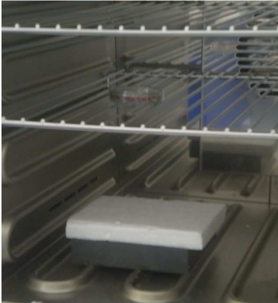
Obr. č. 7 – umístění připravených suspenzí B1 a B2 v sušárně (působení kolmého magnetického pole)
