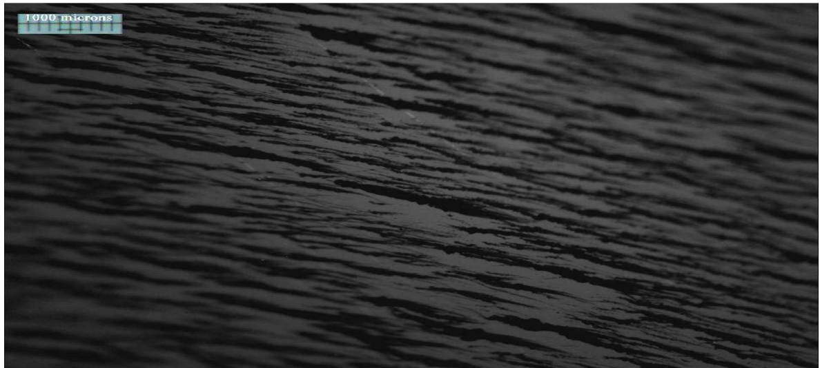
Obr. č. 55 – suspenze C3 - výřez C (PVAL+nanočástice) – skleněná Petriho miska – působení podélným magnetickým polem
