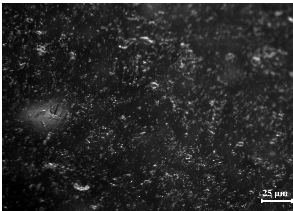
Obr.23 Vzorek po uvolňování PVA 50%, PVC 50%
