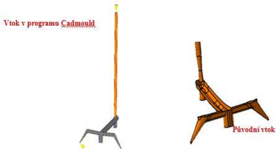
Obr. 52 Úprava vtoku – světlomet
