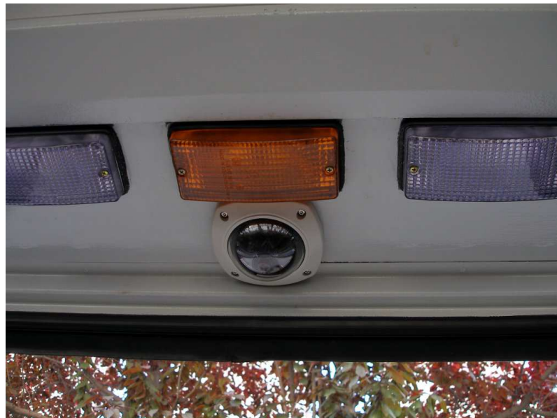
Obrázek 8: Řešení kamerového systému pro vstup a výstup cestujících[8]
