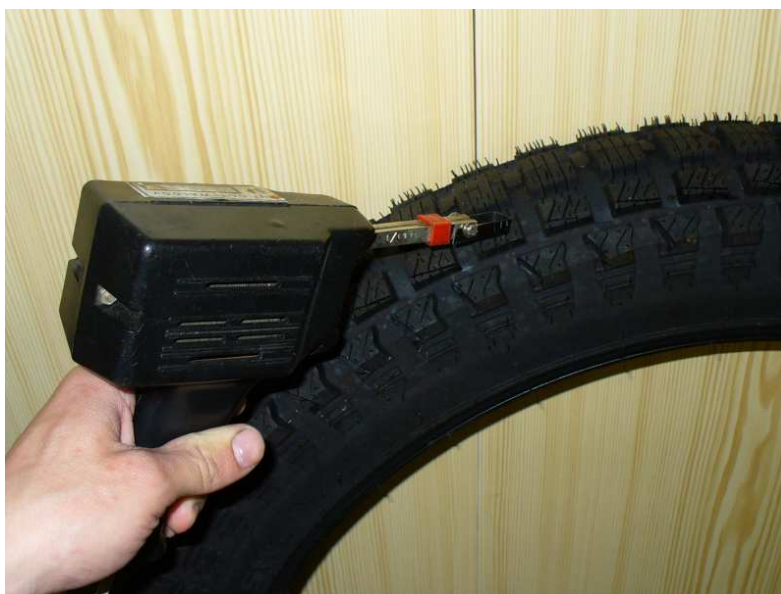
Obr. 26 Řezání dezénu elektricky vyhřívaným nožem
