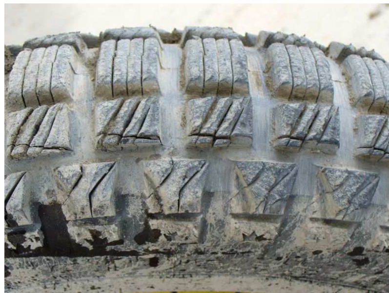
Obr. 28 Upravený plášť po testování
