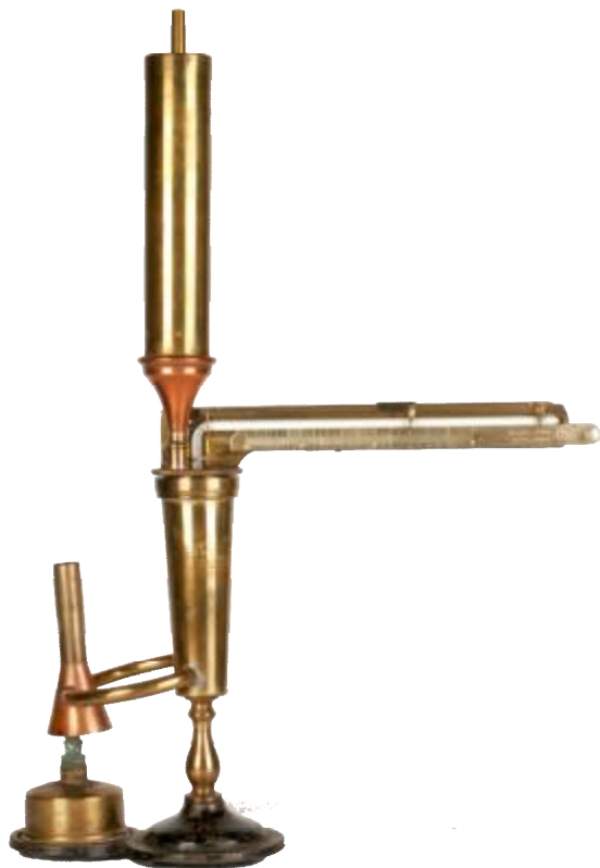
Obr. 16. Ebulioskop podle Malliganda [29]
