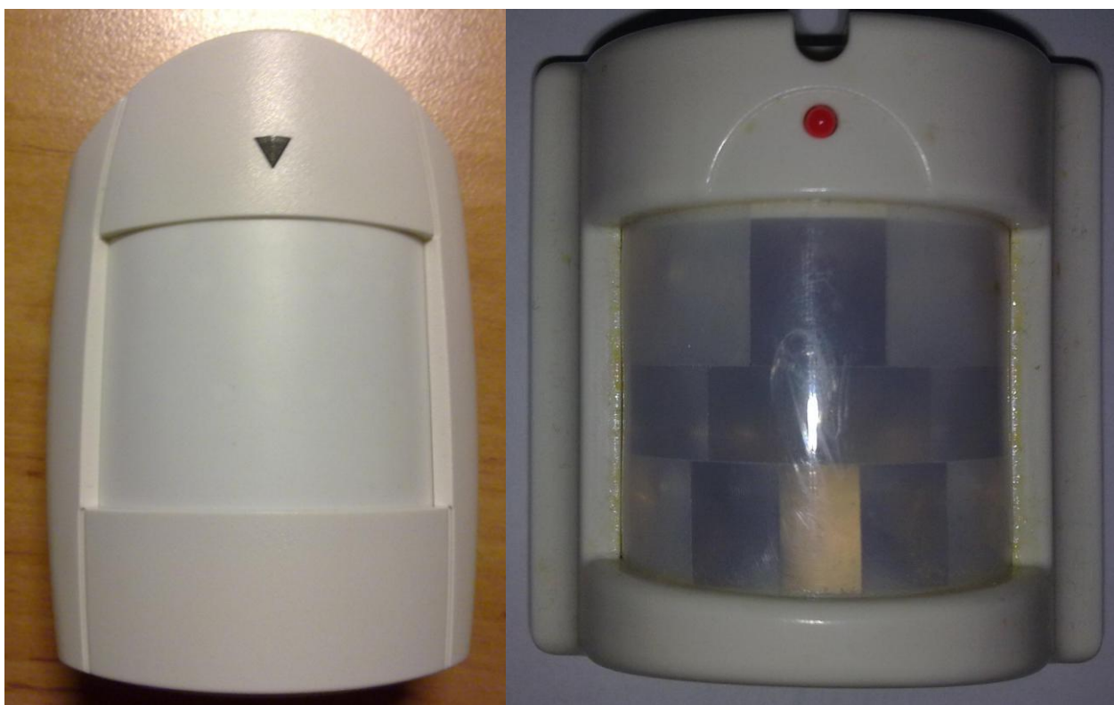
Obr. 14 Zkoušené PIR detektory (vlevo- novější PARADOX; vpravo – starší typ) – vlastní zdroj
