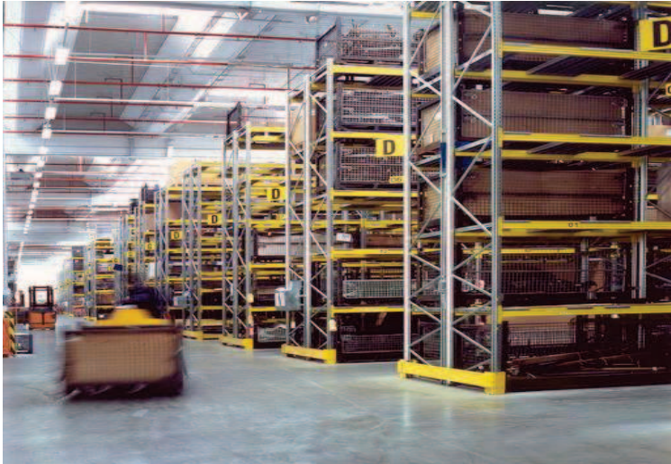
Obr.č. 1 – Příhradové regály [8]
