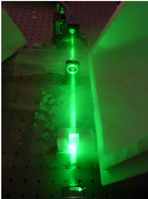
Obrázek 22: Obrázek realizace, průchod záření čočkou a navázání do vlákna
