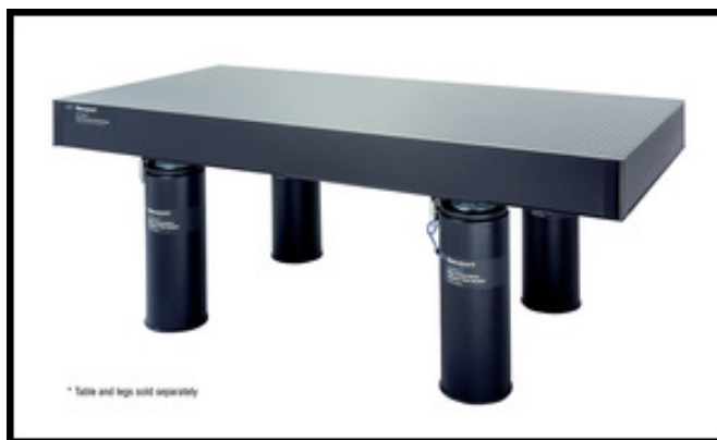
Obrázek 15: Antivibrační stůl s aktivním tlumením [www.newport.com]
